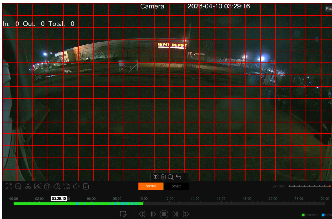
Figure 16-37. Définition de la région de recherche de mouvement avec le cadre de sélection.
