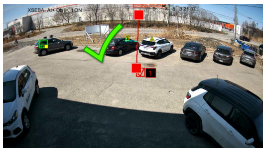
Figure 10-11. Exemple de configuration de la règle de sens de franchissement.
